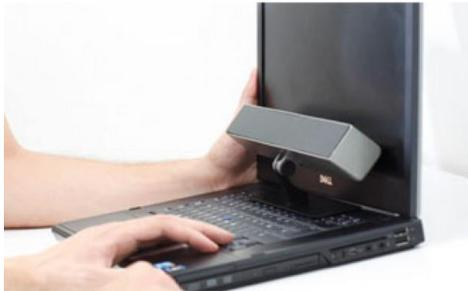
Irisbond Primma est un système comprenant le dispositif de contrôle oculaire de l'ordinateur, l'application Primma correspondante, un programme de communication alternative, une installation à distance, le support technique et les mises à niveau.
