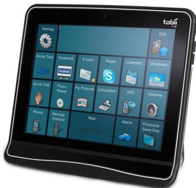
Les Tobii Dynavox I-12+ et I-15+ sont 2 dispositifs pouvant être contrôlés via un oculomètre intégré. Ils ont été conçus pour un usage sur table, au lit ou sur fauteuil roulant. Il permet d'accéder à l'ordinateur, d'utiliser un contrôle d'environnement et la téléphonie. Pour piloter et contrôler via le regard, il faut intégrer un module complémentaire. La validation s'effectue par le clignement des yeux.
