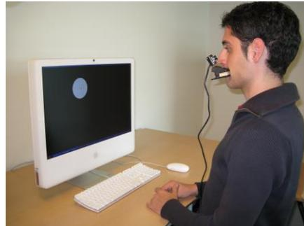
L'**ITU Gaze Tracker** est un logiciel en cours de développement, il a été élaboré par une équipe de l'université de Copenhague. Il s'appuie sur la vidéo infrarouge qui détecte les mouvements des reflets cornéens. L'objectif est de développer une solution de pointage à l'œil à faible coût s'appuyant sur du matériel vidéo grand public.
