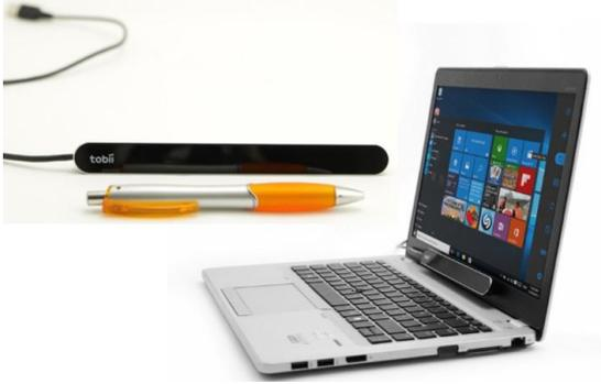
Le Tobii PC Eye Go se présente sous la forme d'un appareil contenant des capteurs/émetteurs infrarouge, qui se fixe sur l'écran de l'ordinateur à l'aide d'un support métallique aimanté. Le PCEye Go est livré avec le logiciel Eye Gaze sélection permettant de cliquer de manière intentionnelle (moins d'erreur de clics) et de naviguer de façon plus intuitive.
