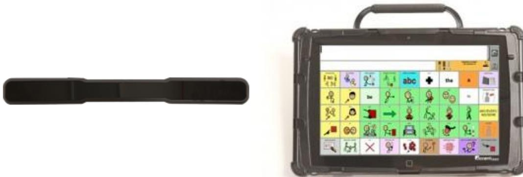
Ce système est une option de l'Accent 1 000 ou 1 400. Il offre un accès complet de l'appareil via un contrôle visuel.
