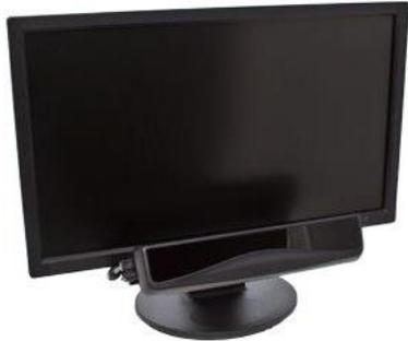
Le PC Eye Explore est un outil simple et amusant pour se familiariser à un dispositif de commande oculaire. Il est destiné aux enfants ou personnes débutantes, afin de les sensibiliser et leur permettre de découvrir la commande par le regard auprès de logiciels simples, compatibles avec la fonction clic gauche déclenchée après fixation du regard : jeux, exercices d'apprentissage, communication...
