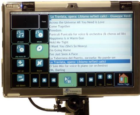
Eye Gaze est un système de pointage à l'oeil doté d'une ou plusieurs caméras montées d'une cellule infrarouge qui suit le regard de la personne. Le rayon est réfléchi par la rétine et se dirige vers un écran tactile.
