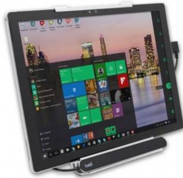
Ce modèle est une nouveauté s'adaptant sur une tablette (Windows 8) mais aussi sur ordinateur portable ou de bureau. Le support de fixation a la particularité d'être identique à celui de son prédécesseur PC EYE GO. Le Tobii EyeMobile se compose de la poursuite oculaire Tobii PCEye Go, le EyeMobile Bracket support polyvalent et une tablette Windows 8 Pro.
