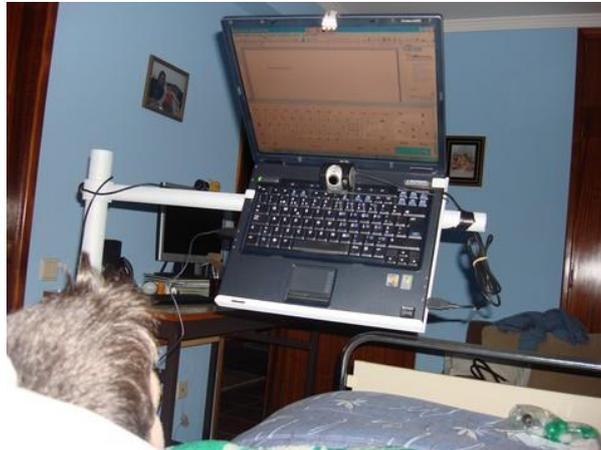
Ce dispositif permettant de commander par le regard est composé d'une caméra et d'un logiciel de paramétrage. Le système comprend un objectif situé au centre pour capter l'œil, et 2 émetteurs infra-rouges. Ces 2 composants nécessitent 2 prises USB. Contrairement à la plupart des systèmes, la caméra doit être positionnée au-dessus de l'ordinateur portable, centrée et au plus proche de l'écran.
