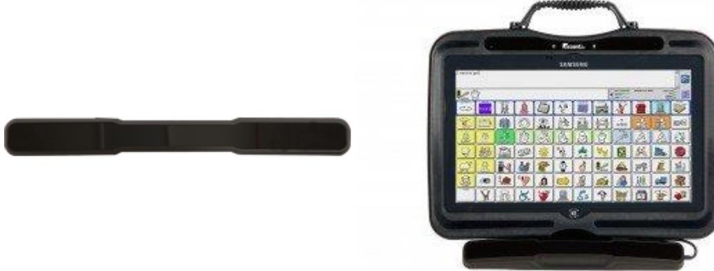
Le système IG-30 nécessite un système de caméra attachée au-dessous de l'écran, que ce soit un ordinateur portable, fixe ou une tablette.
