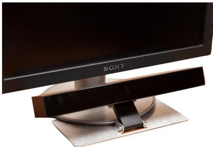
EyeTalk est une solution de suivi oculaire compacte, qui a une fréquence de travail de 60Hz. Le logiciel inclus permet aux utilisateurs de contrôler diverses applications avec leurs vues ou leurs commandes vocales.
