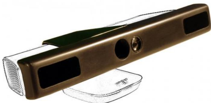
NUIA eyeCharm est un module de suivi des yeux à budget supplémentaire pour les capteurs Kinect. Il peut être utilisé pour faire défiler divers textes vers le haut ou vers le bas, ainsi que pour basculer d'une page à l'autre.
