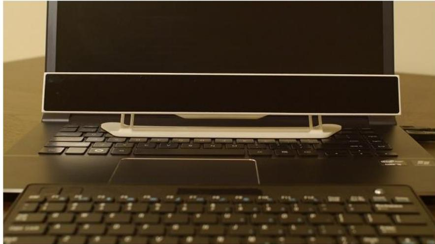
GP3 Eye Tracker est un système de suivi oculaire compact avec une calibration rapide et une fréquence de travail de 60Hz. Il peut être utilisé comme appareil d'assistance ou dans diverses recherches.
