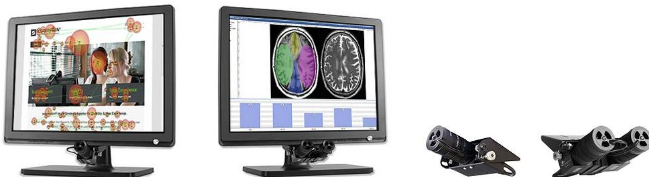
EAS Monocular et EAS Binocular sont des dispositifs de suivi du regard matériels dotés de deux caméras et de hautes fréquences de travail de 60Hz et 120Hz. Utilise la méthode de la "pupille de lumière".
