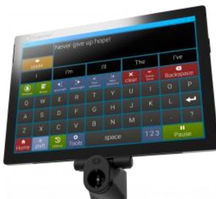
Une caméra de suivi oculaire spéciale montée sous l'écran Eyegaze Edge observe l'un des yeux de l'utilisateur. Un logiciel de traitement d'image sophistiqué analyse les images de la caméra 60 fois par seconde et détermine où l'utilisateur regarde sur l'écran.
